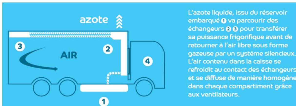
Figure 6.26 Schéma de principe d'un système frigorifique dit « indirect » (source Air Liquide)
